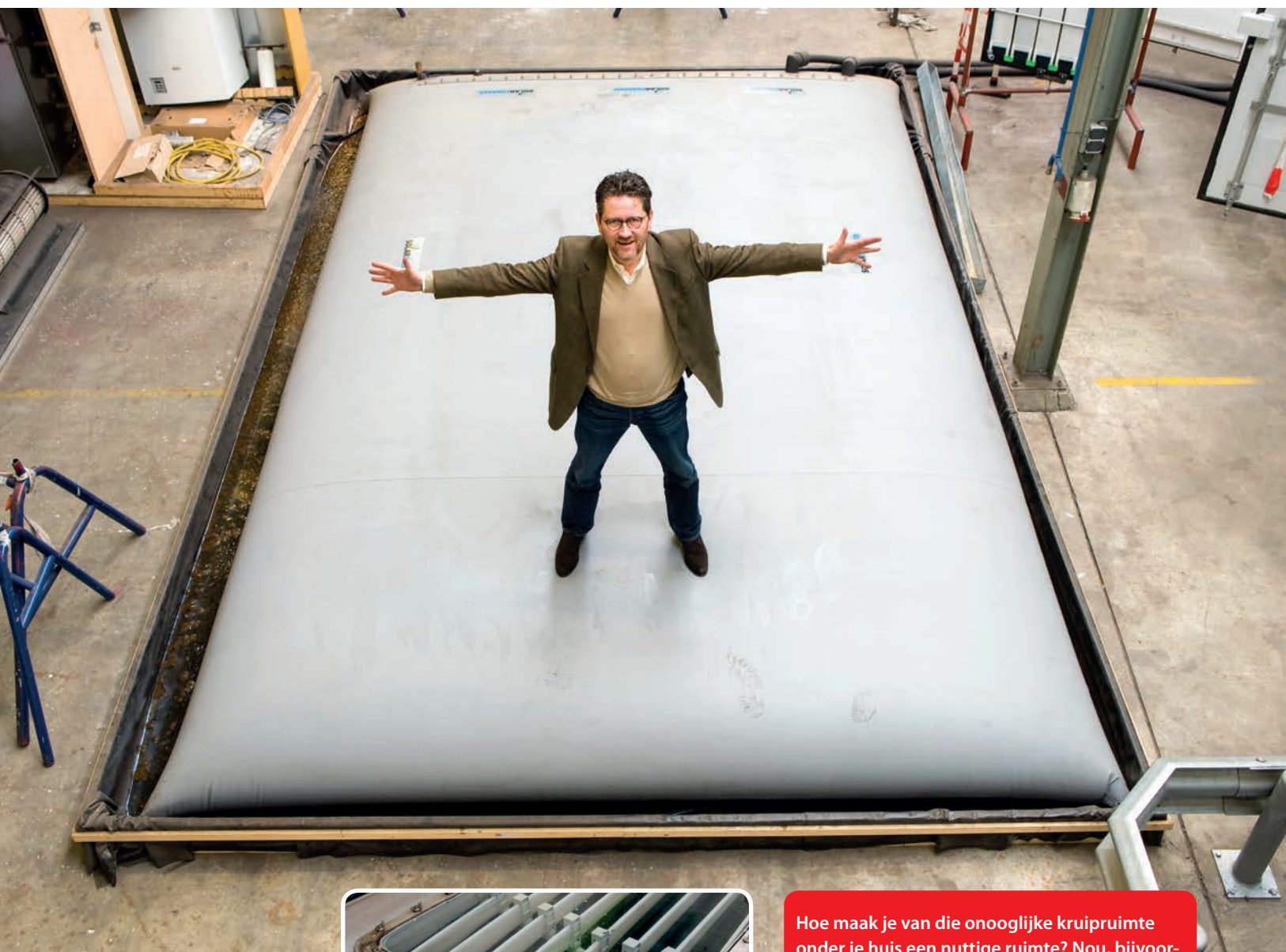
De lamellen in de bufferzak fungeren als warmtewisselaar.
